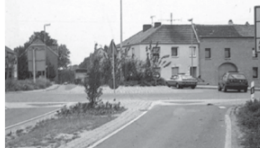
Geschwindigkeitsdämpfung im Ortseinfahrtbereich durch Kreisverkehr
