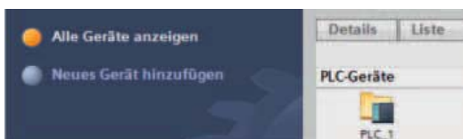
10: Portalansicht mit der eingefügten PLC-Station
