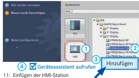
11: Einfügen der HMI-Station (Anzeige-/Bedienpanel)
