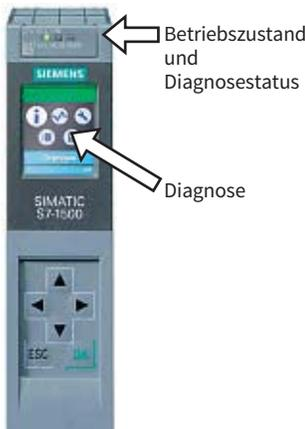
Abb. 5-1: Hardware-CPU der Reihe S7-1500
