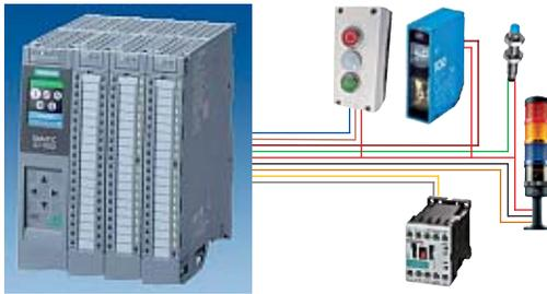
Abb. 9-1: Einzelverdrahtung
