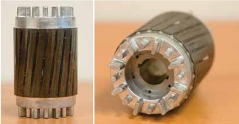
**Bild 1.3** Rotor eines ASM mit Kurzschlusskäfig aus Aluminium
