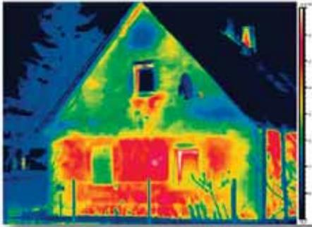
Bildaufnahme mit einer Auflösung von 320x240 Pixel und einer Wärmewempfindlichkeit von  $\leq 50 \mu K$ .
