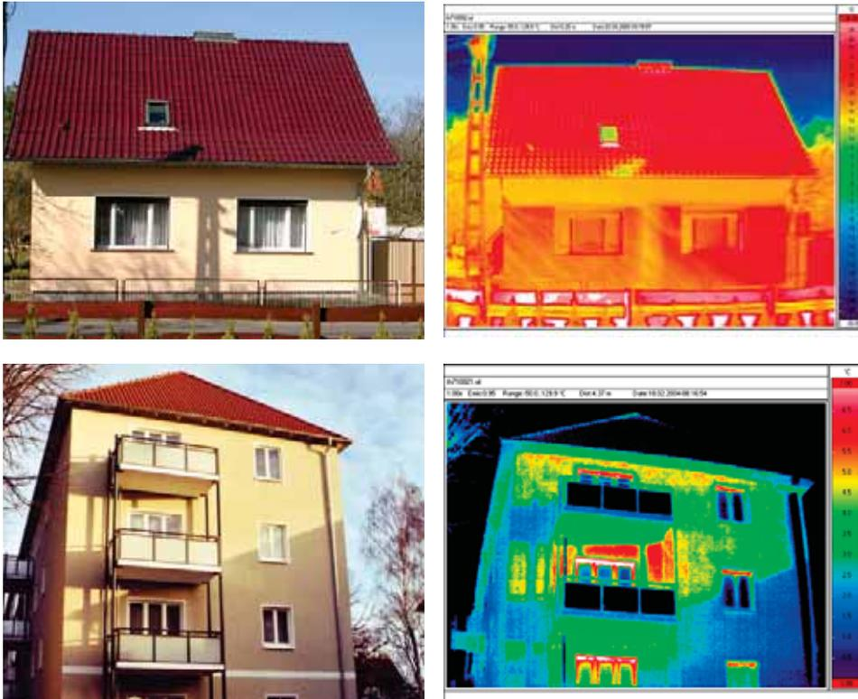
**Bild 6-5** So sollte man es nicht machen: Auswirkungen von Schattenwürfen und direkter Sonneneinstrahlung auf Thermografieaufnahmen.
