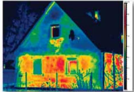
Bildaufnahme mit einer Auflösung von 200x150 Pixel und einer Wärmewempfindlichkeit von  $\leq 70 \mu K$ .
