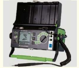
Messgerät zur Prüfung nach VDE 0701 und VDE 0702
