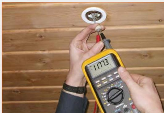
**Bild 1: Spannungsmessung an einer Niedervolt-Halogen-Beleuchtungsanlage**
