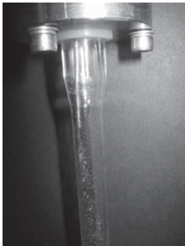
Bild 119: Bei diesem Kapillarrohr, das in einem Glasrohr endet, ist der Einspritzvorgang deutlich zu erkennen.
