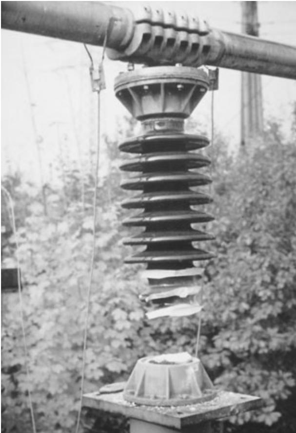
**Bild 3.1** Gebrochener Stützer nach Überstrom (Quelle: FGH)
