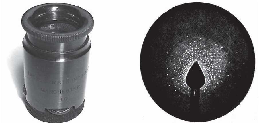
Bild 4.3 Das Spintariscope und die Aufleuchtungen unter einem Radiumpräparat (Quelle: Foto des Verfassers, Graetz, L.: Die Elektrizität, wie Anm. [3], S. 384. Fig. 350)
