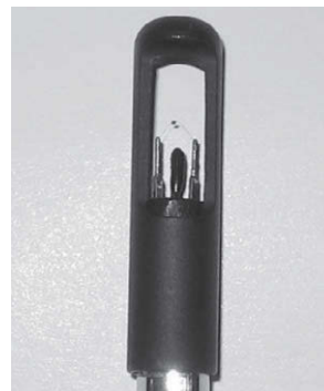
Bild 96: Messsonde eines Hitzdraht-Anemometers auf einem Teleskopstab (Testo).
