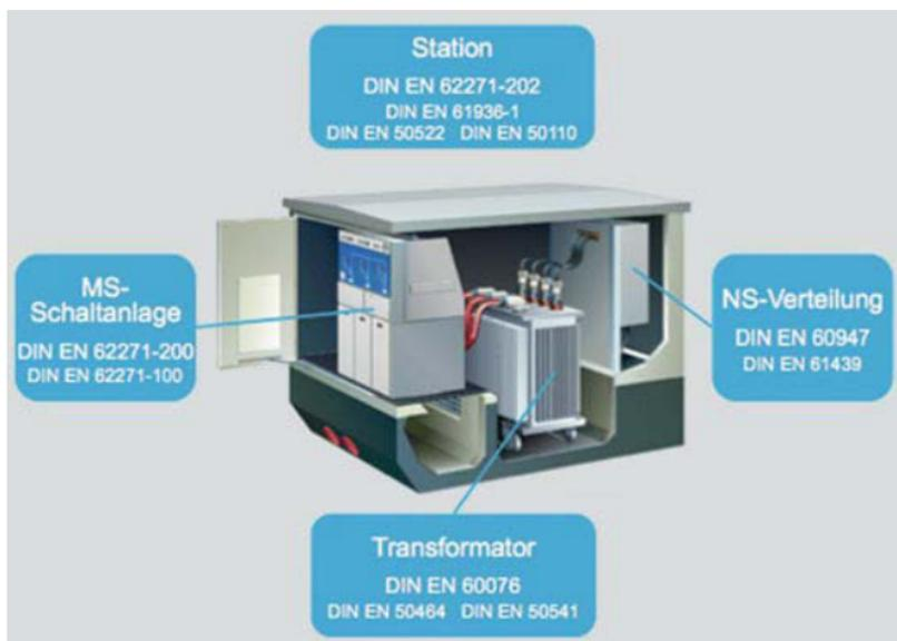
Bild 5.1: Übersicht über elektrotechnische Leitnormen von Stationshauptbauteilen
