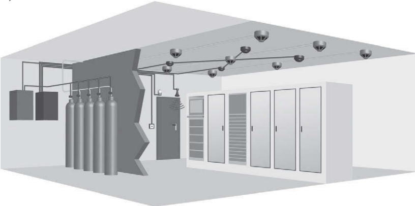
Bild 1.17 Beispiel einer Gaslöschanlage – a) Gasflaschen der Hauptbatterie, b) prinzipieller Aufbau Quelle: Calanbau Brandschutzanlagen GmbH, Sarstedt [5]
