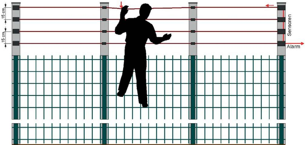
Abb. 4.2.1: Prinzip einer Drahtzugmeldeanlage
