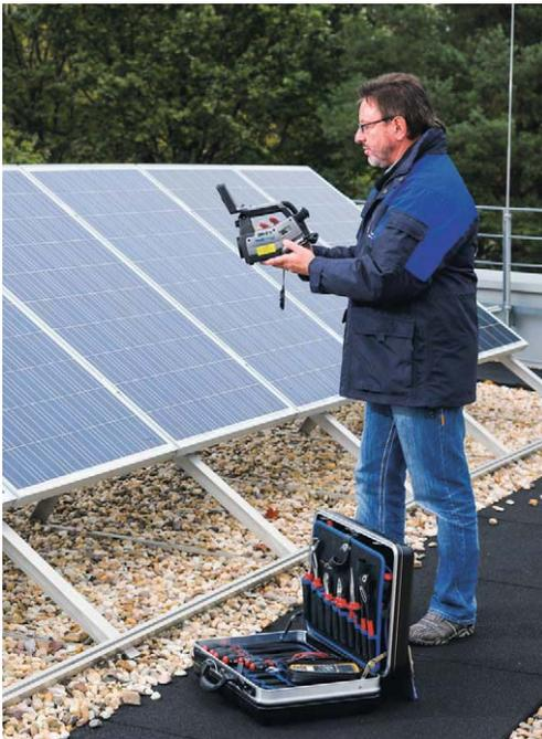
**Abb. 4.5:** Die vorsorgende Inspektion der Solarmodule auf Korrosion und Hotspots gehört zur regelmäßigen Wartung. Mit Hilfe von Fotos und thermografischen Aufnahmen werden Risiken und potenzielle Brandherde rechtzeitig aufgespürt. (Foto: TÜV Rheinland)
