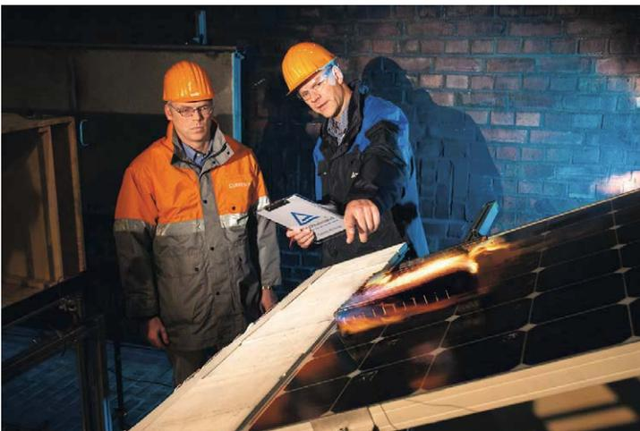
**Abb. 4.6:** Rund 200 Brandfälle mit Photovoltaikanlagen hat der TÜV Rheinland systematisch analysiert. In zahlreichen Tests wurden die Ursachen für Brände ermittelt, um die Schutzvorschriften zu verfeinern. (Fotos: TÜV Rheinland)
