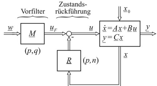
Bild 9-4: Aufbau einer Zustandsregelung als Zustandsrückführung mit Vorfilter
