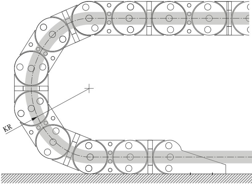
Bild 7.2 Leitungspositionierung in der neutralen Zone einer Schleppkette
