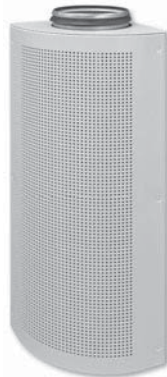
Bild 6.8: Freistehender Quellluftauslass in Viertelkreisform zum freien Einsatz in Räumen oder zur Aufstellung an Wänden bzw. Raumecken (Fa. TROX GmbH)
