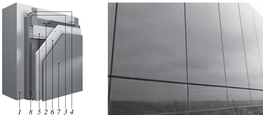
**Bild 2.78** Beispiel einer Photovoltaiktechnik in vorgehängten hinterlüfteten Fassaden
