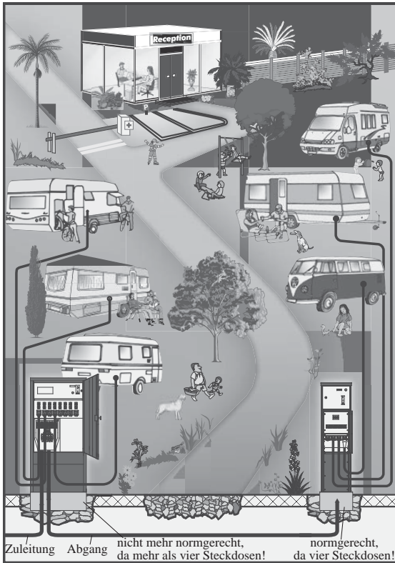
Bild 9.1 Schemadarstellung – Versorgung der Stellplätze mit jeweils einer Steckdose; max. vier pro Verteiler Quelle: Walther-Werke – Ferdinand Walther GmbH, Eisenberg
