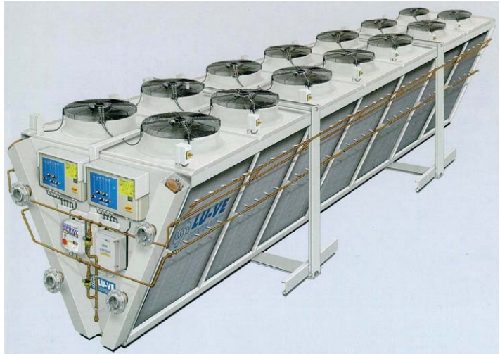
Abb. 4.40 Hybrid-Verflüssiger (LU-VE) in V-Form für große Leistungen im Megawatt-Bereich. 14 Ventilatoren sorgen für kräftige Konvektion. Bei hohen Außentemperaturen kann Wasser über das außen angebrachte Rohrsystem versprüht werden, sodass durch die Verdunstung ein übermäßiges Ansteigen der Verflüssigungstemperatur verhindert wird.
