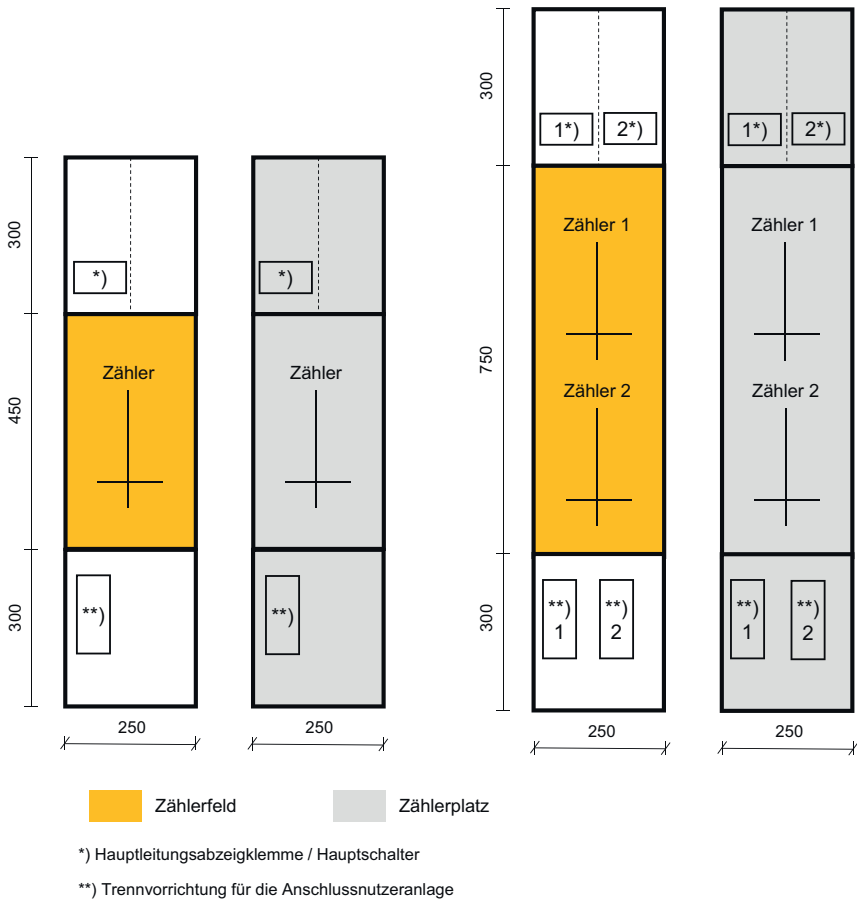
Bild 11.4 Zählerplätze nach DIN VDE 0603-2-1 für Zähler mit Drei-Punkt-Befestigung (Grafik: Michael Fuchs)
