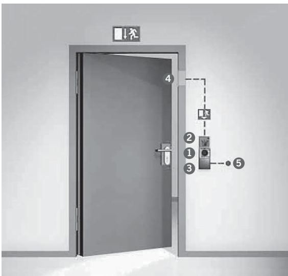
Bild 2.74 Tür im Rettungsweg mit elektrischer Verriegelung und Nottaster (Schema)
