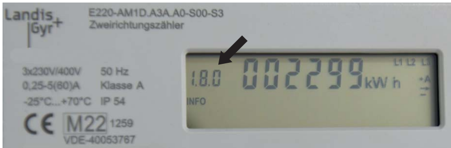
Bild 7.7 Kennzeichnung der aus dem Netz entkommenden elektrischen Energie
