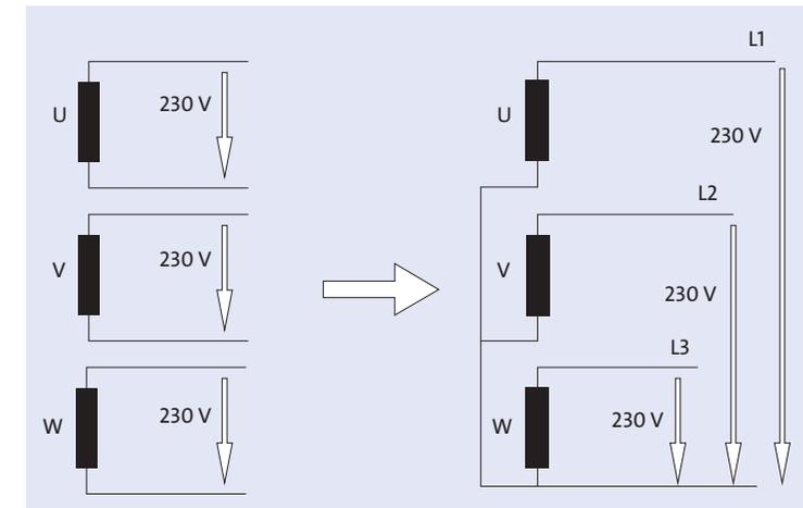
**Abbildung 9.3** Sternschaltung der Spulen U, V und W
