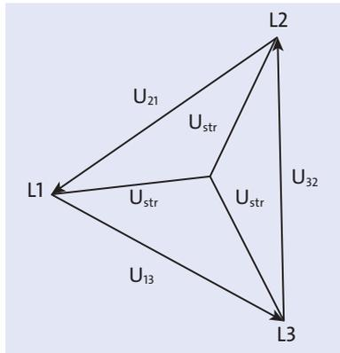
**Abbildung 9.21** Zeigerdiagramm einer Sternschaltung mit symmetrischer Ohm'scher Belastung
