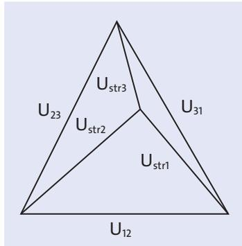
**Abbildung 9.28** Zeigerdiagramm der Sternschaltung mit unsymmetrischer Ohm'scher Belastung ohne Anschluss des N-Leiters
