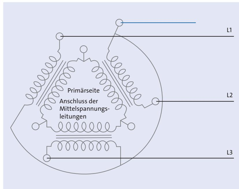
Abbildung 9.6 Transformation von Mittelspannung zu Niederspannung (230 V)
