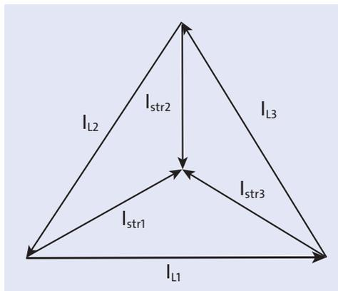
**Abbildung 9.13** Zeigerdiagramm einer Dreieckschaltung mit rein Ohm'scher Belastung
