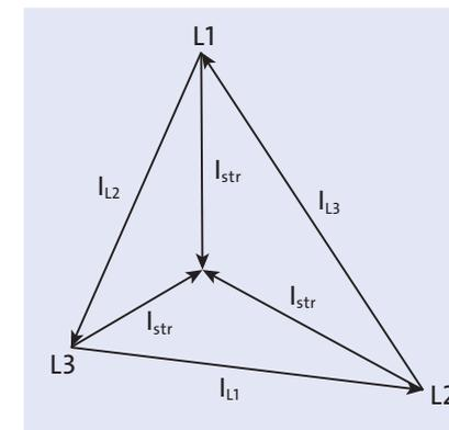
**Abbildung 9.24** Ströme einer Dreieckschaltung mit unsymmetrischer Belastung
