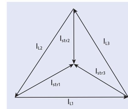
**Abbildung 9.23** Ströme einer Dreieckschaltung mit symmetrischer Belastung
