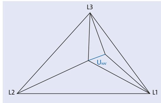
Abbildung 9.30 Sternpunktverschiebung
