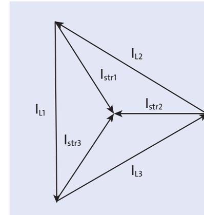
**Abbildung 9.15** Zeigerdiagramm einer Dreieckschaltung mit rein induktiver Belastung
