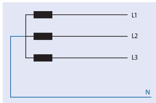
**Abbildung 9.22** Vierleitersystem; der N-Leiter ist am Sternpunkt angeschlossen.
