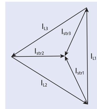
**Abbildung 9.16** Zeigerdiagramm einer Dreieckschaltung mit rein kapazitiver Belastung
