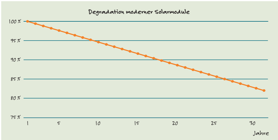
Abbildung 6.2 Beispiel der Degradation von Solarzellen
