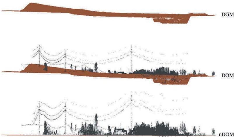
**Abb. 19.1:** Darstellung der Derivate DGM, DOM und nDOM aus LiDAR-Daten (Quelle: WICHT 2012)
