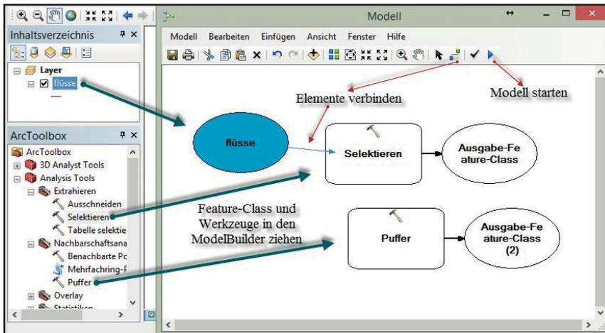
Danach ziehen Sie auch die beiden benötigten Werkzeuge „Selektieren“ und „Puffer“ aus der ArcToolbox in das ModelBuilder-Fenster.
