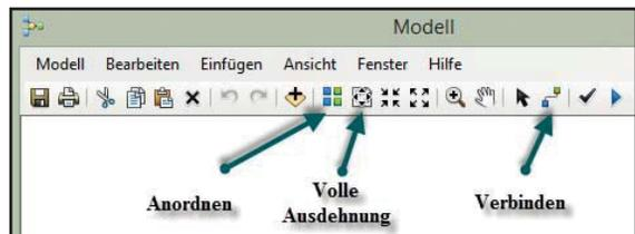
Um die Werkzeuge und Daten des fertigen Modells optimal im Modellfenster darzustellen, betätigen Sie zuerst die Schaltfläche „Anordnen“ und danach die Schaltfläche „Volle Ausdehnung“. Das Modell sollte dann etwa wie in folgender Abbildung aussehen:
