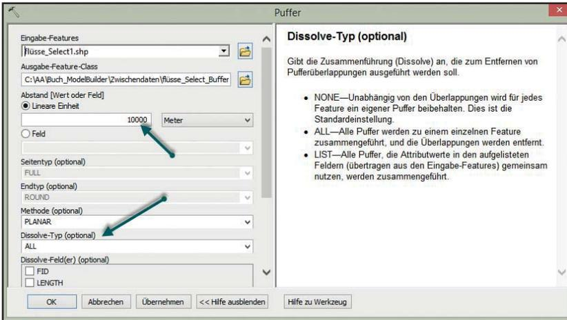
In diesem Beispiel wurden die Puffergröße (10000 Meter) und der Parameter „Dissolve-Typ“ auf „All“ eingestellt. Damit werden alle erzeugten Puffer zu einem einzigen zusammengefasst.
