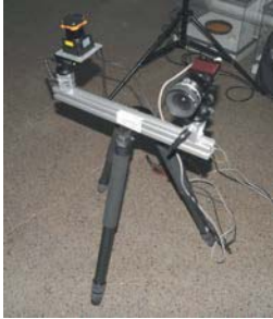
Abb. 2: Experimentelle Plattform mit Kamera und Zeilenlaserscanner
