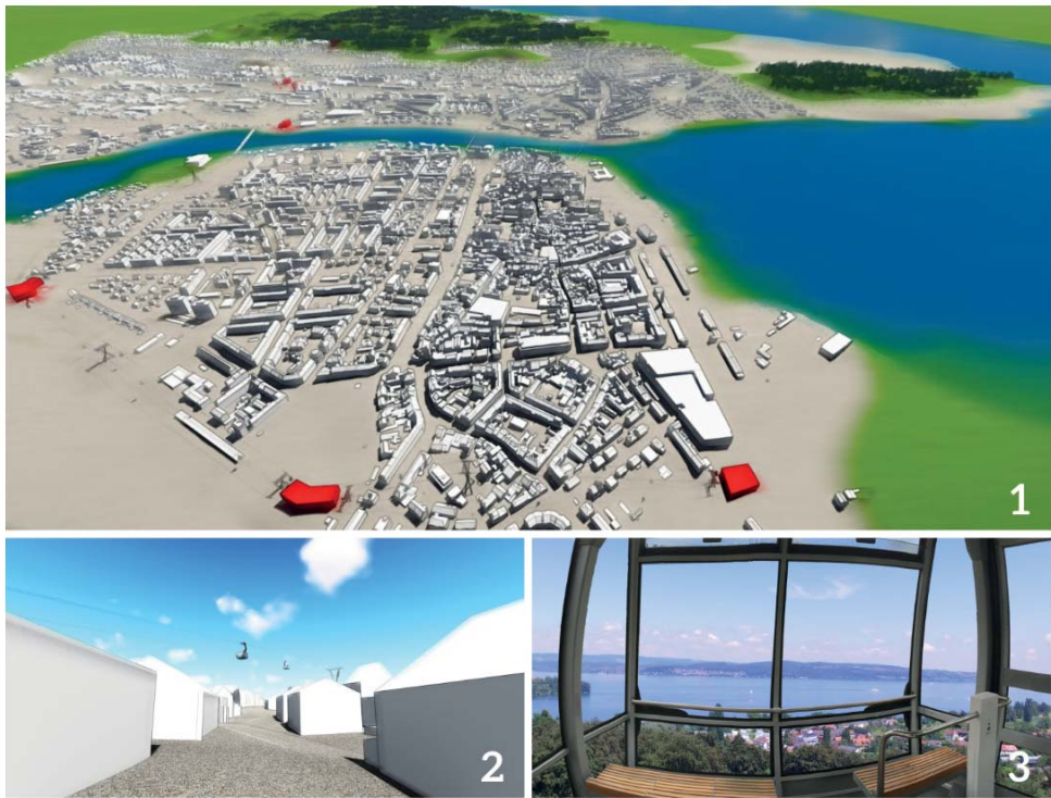
Abb. 3: 3D-Stadtmodell der Stadt Konstanz, generiert in CityEngine (1) und als echtzeitfähiges Modell mit planungsrelevanten Inhalten in Lumion visualisiert (2), Mixed Reality Film aus einer Gondel (3) (BUSCHLINGER et al. 2016).
