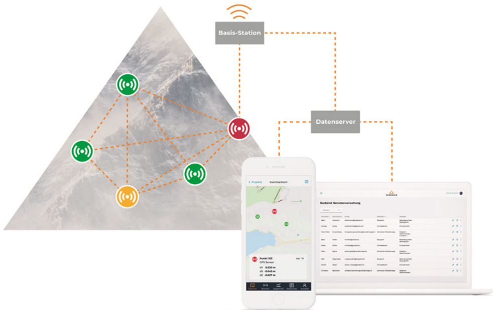
Abb. 2: Komponenten von Wiserock und Kommunikationswege
