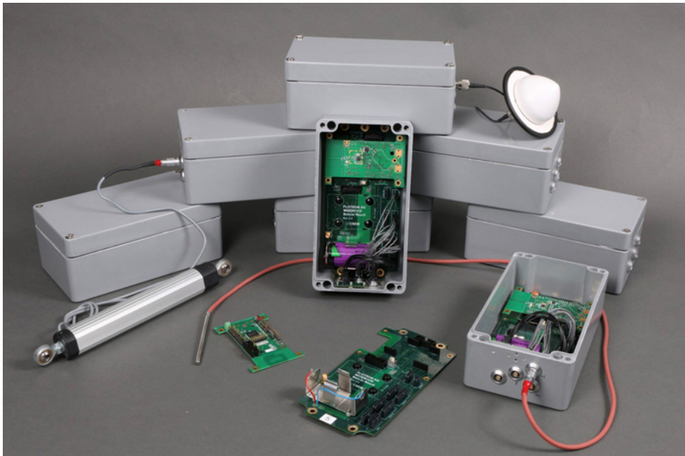
Abb. 1: Prototypen der Sensorknoten mit diversen externen Sensoren
