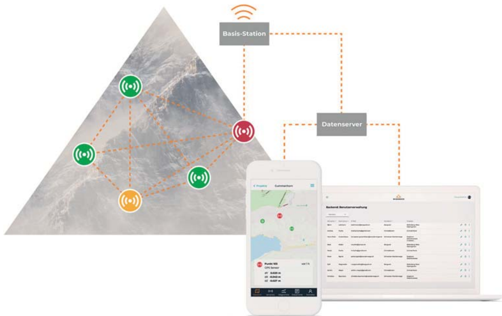
Abb. 2: Komponenten von Wiserock und Kommunikationswege
