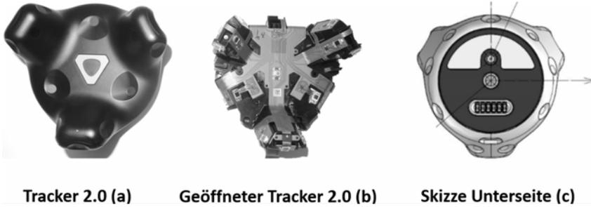
**Abb. 3:** VR-Tracker: geschlossene Ansicht (a), geöffneter Tracker (b), Skizze der Unterseite (HTC 2017).
