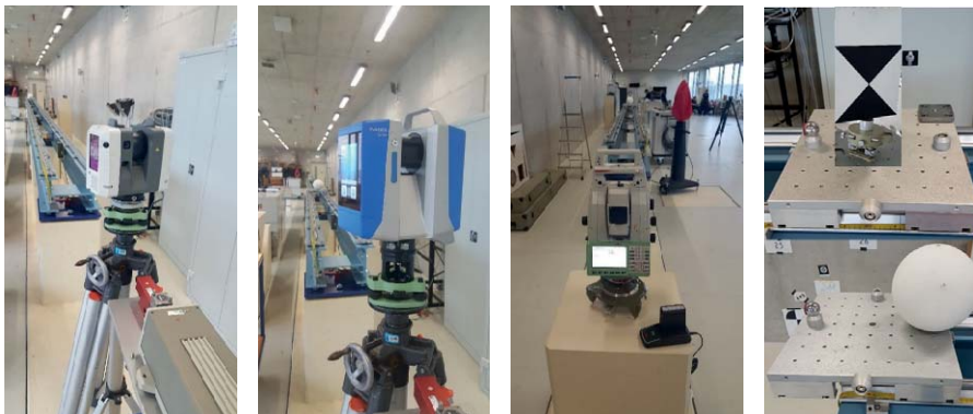
Abb. 5: V. l. n. r.: Leica RTC360, Z+F IMAGER 5016, Leica TS60 (Referenzmesssystem) sowie Zielzeichen und Kugel auf dem Schlitten
