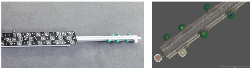
**Abb. 2:** Einer der zwei Kalibrierkörper (links) und die berechneten Mittelpunkte nach der Erfassung (rechts)
