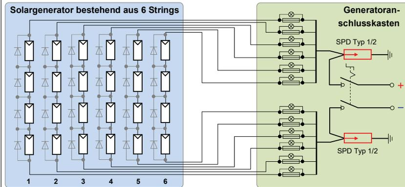
**MERKE:** PV – Anlagen stehen bereits bei geringstem Lichteinfall unter Spannung. Ein Gleichstromhauptschalter ist deshalb zwingend erforderlich und muss unter Volllast die Speisung zum WR schalten können!
