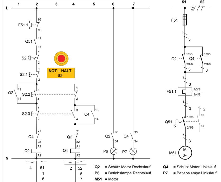
**MERKE:** Wie bereits erwähnt, muss selbst beim Einsatz einer SPS aus Sicherheitsgründen die Schützenverriegelung hardwaremässig erfolgen. Ein SPS – Programmzyklus ist i.d.R. deutlich schneller als das Schalten eines Schützes, was zu einem Leiterschluss führen könnte!
