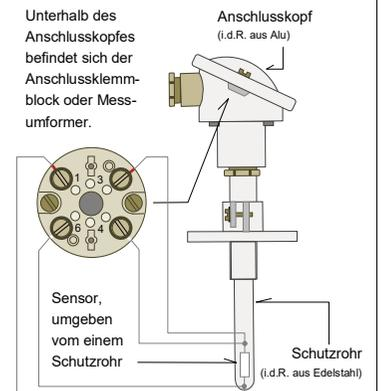
Für besondere Anwendungen gibt es Pt50, Pt200, Pt500 und Pt1'000. Je höherwertiger die Messwiderstände, desto einfacher die Messschaltung und geringer der Einfluss der Zuleitungswiderstände auf den Messwert.
