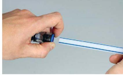
2. Montieren eines Verbinders
